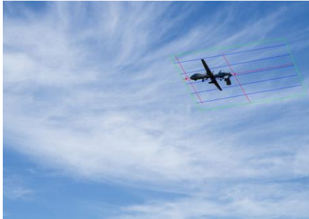
شکل ۱۴- اندازه گیری یک پهپاد در فاصله ۲ کیلومتری از سطح زمین
