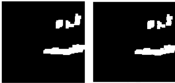
شکل ۵- عملگرهای مورفولوژی (الف) مورفولوژی باز (ب) مورفولوژی بسته
