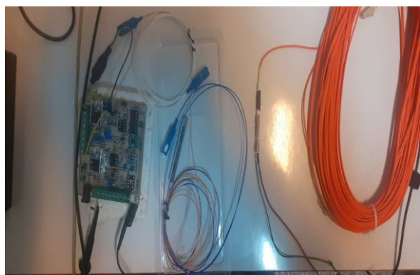
شکل ۱۰- چیدمان آزمایشگاهی otdr
